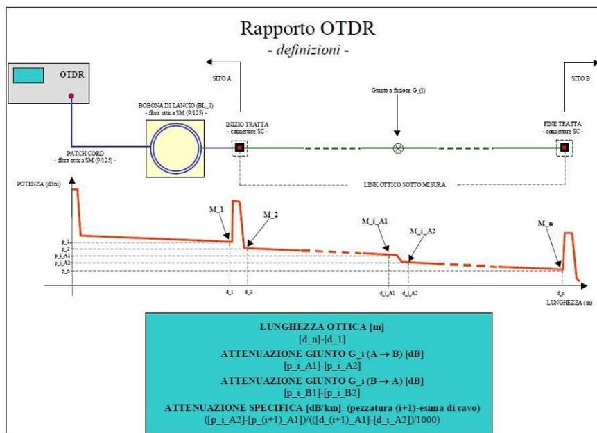
Figura 1 – Schema di misura: report OTDR
