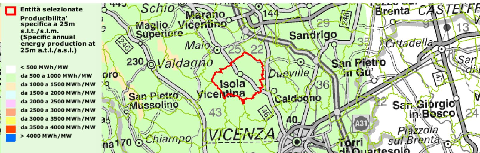
Dall'immagine è possibile constatare che la velocità media del vento a 25 m s.l.m. è inferiore a 3 m/s. Tale velocità non sufficiente a garantire una produzione elettrica discreta. Anche la producibilità specifica del vento a 25 m s.l.m. è bassa, compresa tra i 500 e i 1.000 MWh/MW.
