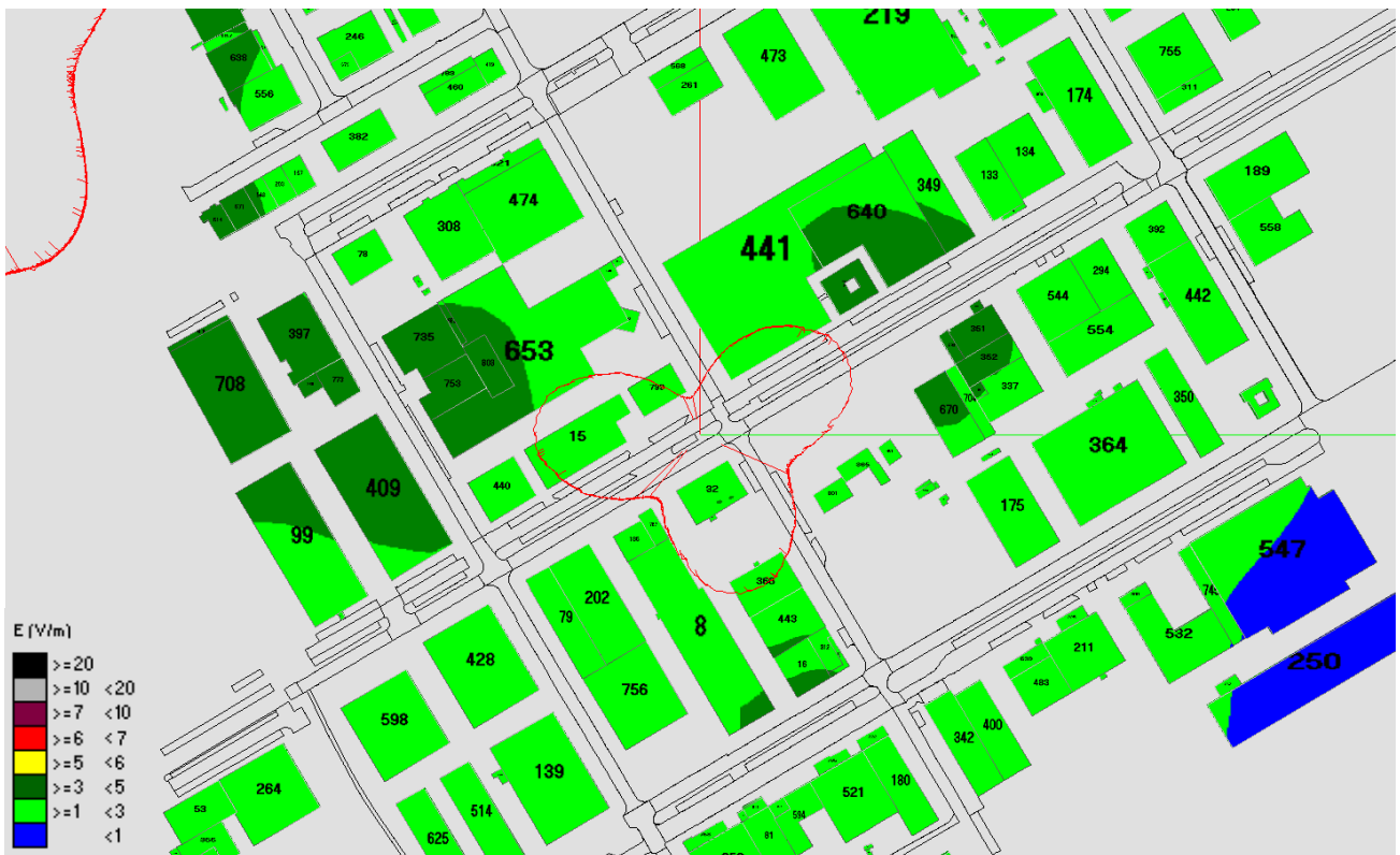
Fig. 43 Impatto elettromagnetico – zona Parcheggio Via Lago di Albano – Vista dall'alto senza solido
