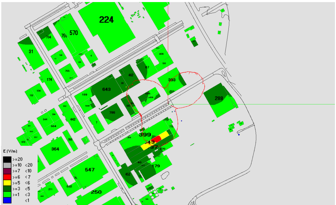
Fig. 48 Impatto elettromagnetico – zona Parcheggio Via Lago di Costanza – Vista dall'alto senza solido
