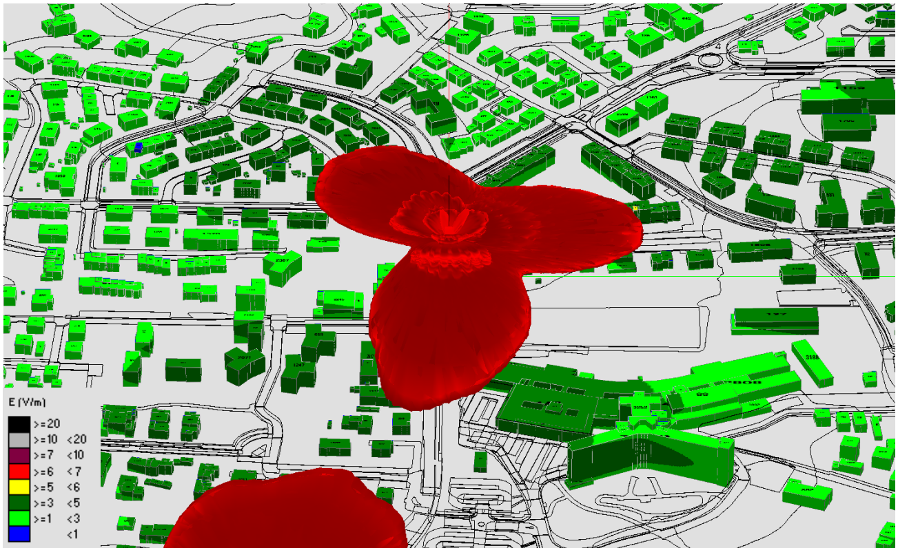
Fig. 17 Impatto elettromagnetico – zona Terreno via della Potara – 0° N
