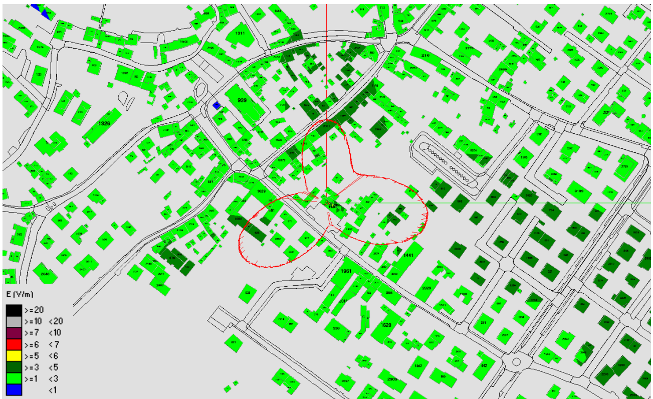
Fig. 83 Impatto elettromagnetico – zona Via Camin – Vista dall'alto senza solido
