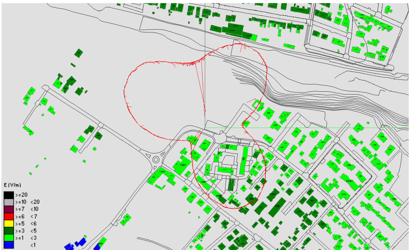
Fig. 68 Impatto elettromagnetico – zona Parcheggio via Parafitta – Vista dall'alto senza solido
